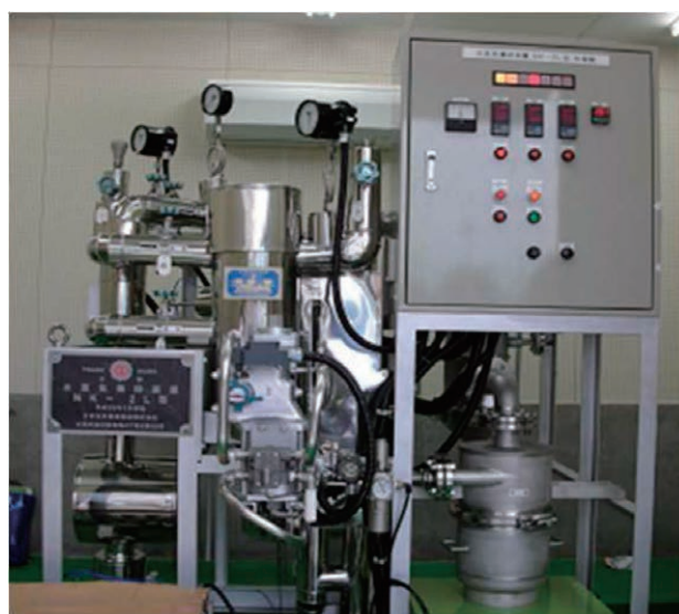
図1 水蒸気爆砕装置
